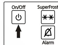
**Выключение:** Нажмите кнопку ON/OFF и удерживайте ее нажатой в течение ок. 3 секунд, чтобы погас индикатор температуры.
