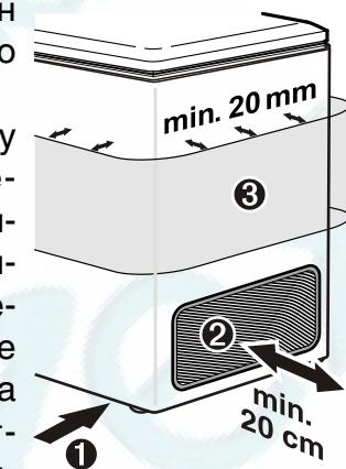
② Промежуток между вентиляционной решеткой и стеной должен составлять минимум 20 см. Этот промежуток ни в коем случае нельзя заставлять, а вентиляционные отверстия нельзя закрывать.
