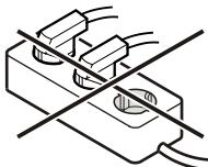
Не используйте автономные инверторы (преобразователи постоянного тока в переменный или трехфазный ток) либо энергосберегающие разъемы. Опасность повреждения электронного оборудования!
