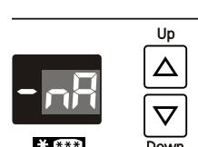
Если во время отображения **nA** нажать на кнопку выключения аварийной сигнализации ("**ALARM**"), на индикаторе появится значение самой высокой температуры, установившейся во время отсутствия напряжения в сети. В зависимости от нагрева или даже размораживания следует проверить качество пищевых продуктов и принять решение об их дальнейшем использовании!
